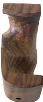
Base d'appoggio laterale posteriore troppo spessa Spazio per la tabacchiera stretto a sinistra, troppo largo a destra
